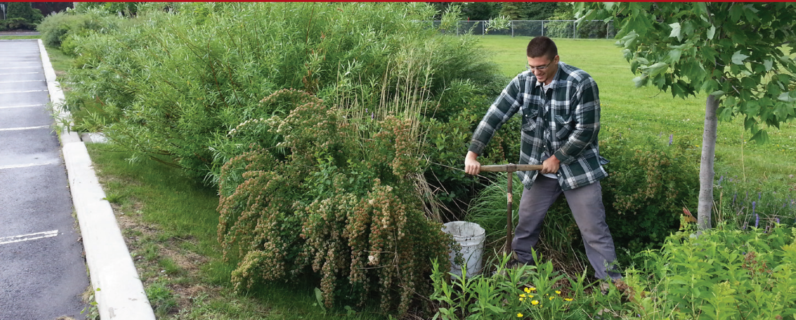
Bassin de biorétention du Centre-Civique de Mont-St-Hilaire, test de taux d'infiltration du terreau en place.
